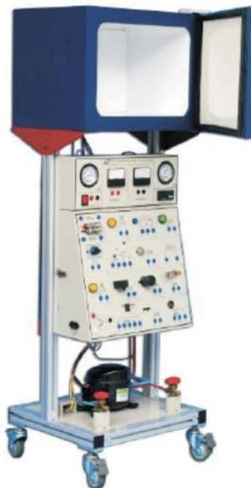
El Sistema de entrenamiento en refrigeración cuenta con los siguientes elementos: compresor-condensador-filtro secador-vidrio de visión-válvula de expansión- evaporador-compresor.
